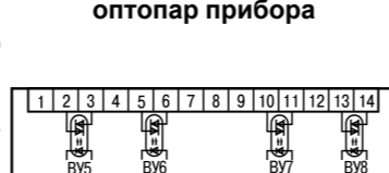
Рисунок 14 – Схема подключения транзисторных оптопар прибора
