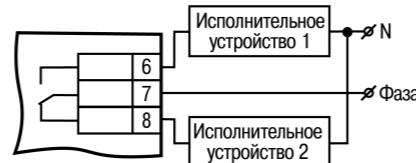
Рисунок 12 – Схема подключения нагрузки к ВУ типа «Р»
