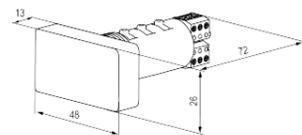
Рисунок 3 – Габаритные размеры прибора
