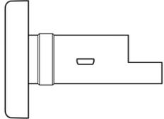
Рисунок 11 – Расположение разъема microUSB
