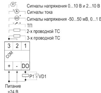
Рисунок 6 – Схема подключения входных сигналов и питания
