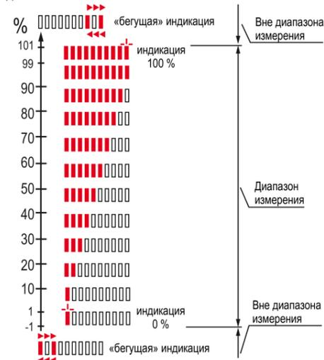
Рисунок 8 – Отображение измеряемого сигнала
