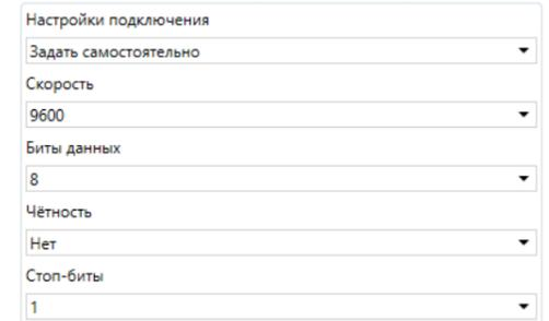
Рисунок 19 – Настройка подключения
