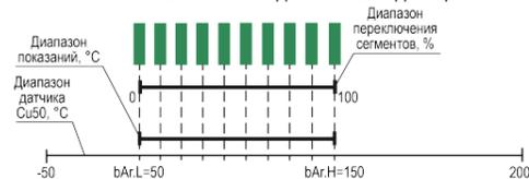
Рисунок 13 – Настройка диапазона индикации
